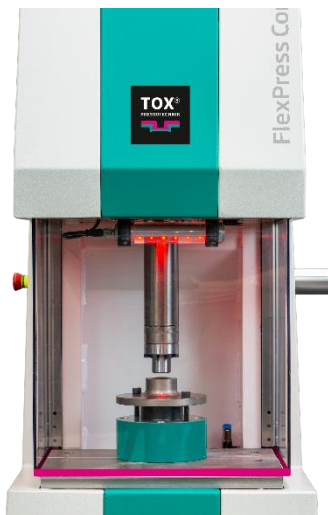
Bild 2: Die RGBW-Beleuchtung des Arbeitsraums leuchtet rot auf, wenn der Arbeitsprozess nicht nach Vorgabe lief und die Werkstücke nicht in Ordnung sind.
